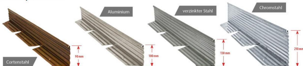
Winkelprofil Basic ergänzt das schon bestehende Produktsortiment unserer Winkelprofile. Es verfügt über 3 trapezförmig auf- liegende Flächen und ist somit nur für den geradlinigen Einbau geeignet. Winkelprofil Basic ist problemlos mit unseren bestehenden Winkelprofilen kombinierbar. Standardlänge ist jeweils 2400 mm.
