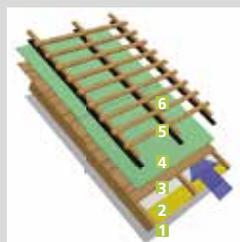
**1 Kaltdach mit Hinterlüftung**
